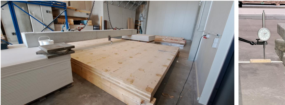
Abbildung 47: Abbildung des Mess-Setups zur Bestimmung der ersten Eigenfrequenz und der Durchbiegung bei 100 kg Punktlast in Deckenmitte
