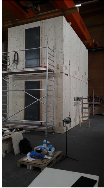
Abbildung 55: Modell-Module in 1:1 zur Untersuchung der Trittschalldämmung von Deckenbauarten in Modulbauweise messbereit
