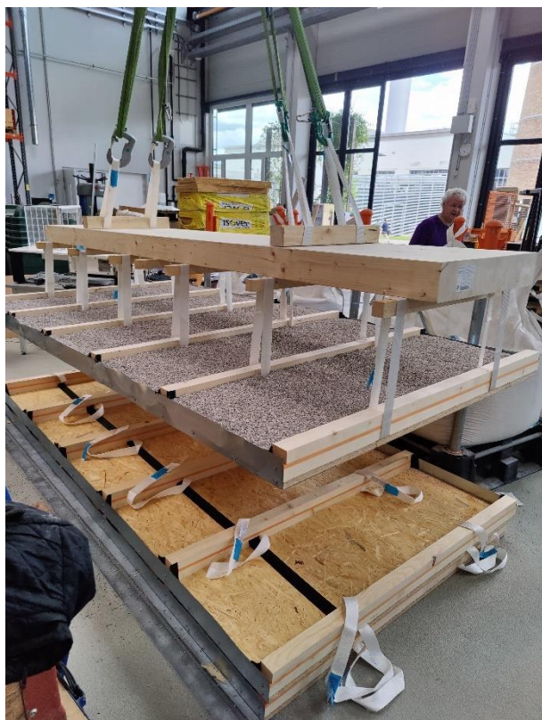
Abbildung 38: Beispielfoto einer Messsituation eines Deckenaufbaus mit dem Fußbodensystem „Linie“ auf einer Brettstapeldecke
