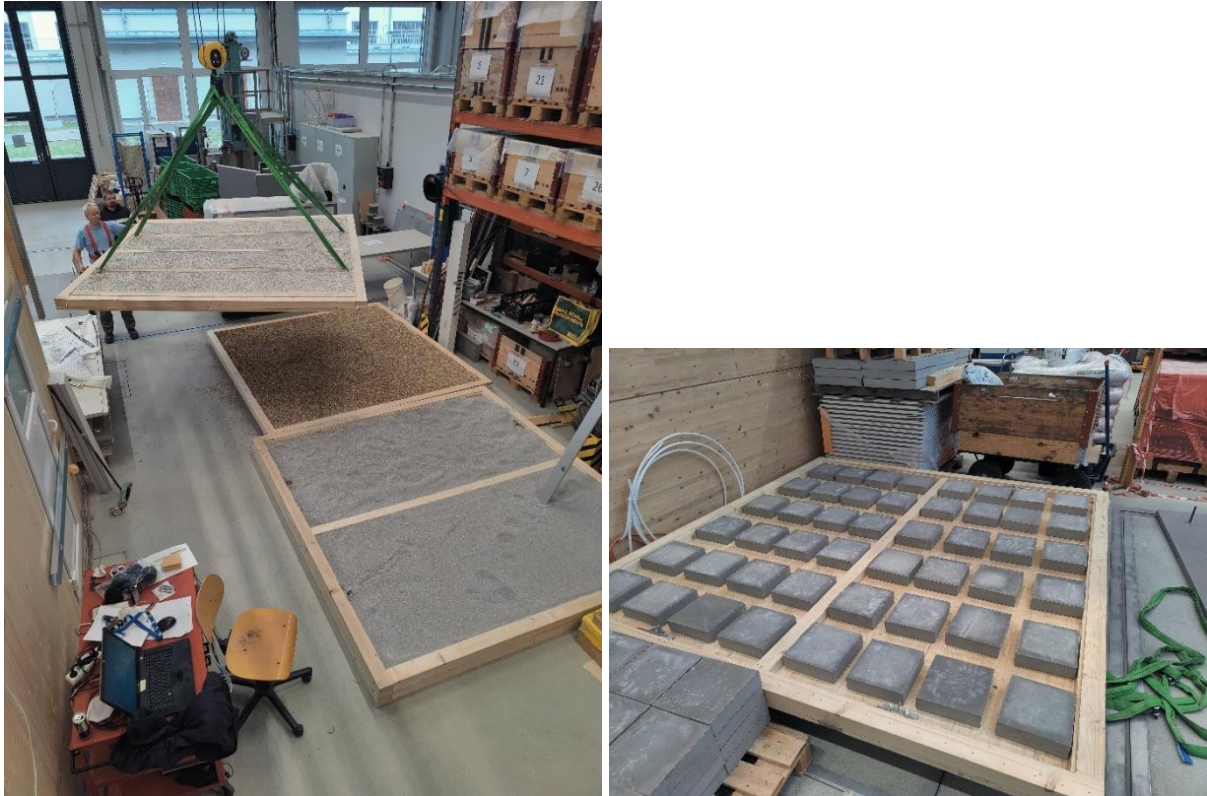
Abbildung 6: Darstellung der unterschiedlichen Schüttungsmaterialien (links) und der verwendeten Betonplatten (25 cm x 25 cm x 7 cm) als Alternative zur Deckenbeschwerung (rechts).
